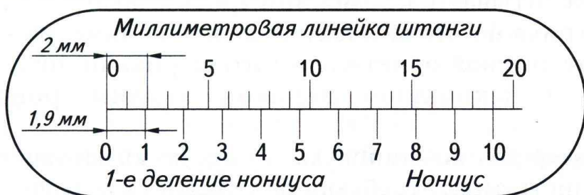
Рис. 64. Шкала штанги и нониус
